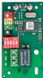
Signalmodul der PG - Ausgänge. Es bietet einen Schaltkontakt für das Ausgangssignalrelais. Es kann z.B. für die Steuerung eines elektrischen Türschlosses, zur Sperrung und zur Anzeige verwendet werden.
