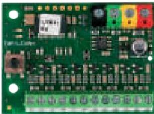
JA-118M Bus-Sammelmodul für den Anschluss von Magnetkontakten. Bietet 8 Eingänge, die speziell für den Anschluss von magnetischen Meldern konzipiert werden. Abmessungen: 50 x 38 x 14 mm
