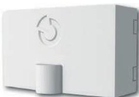
Der Busisolator JA-110T dient zur Trennung und zum Schutz der nicht geschützten Teile der Busleitung. Das Produkt ist aus dem Bus der Zentrale gespeist und kann in die Installationsdose JA-190PL montiert werden. Dem Modul wird keine Adresse zugeordnet (besetzt im Alarmsystem keine Position).
