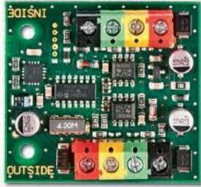
Der Busisolator JA-110T dient zur Trennung und zum Schutz der nicht geschützten Teile der Busleitung. Das Produkt ist aus dem Bus der Zentrale gespeist und kann in die Installationsdose JA-190PL montiert werden. Dem Modul wird keine Adresse zugeordnet (besetzt im Alarmsystem keine Position).
