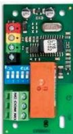
Das BUS-Ausgangsmodul JA-110N mit einem schaltbaren PG-Ausgangsrelais (8 A) mit NO- oder NC-Einstellung. Der jeweilige PG- Ausgang kann mit Hilfe des DIP-Schalters eingestellt werden (schaltet einen der PG-Ausgänge 1–32).
