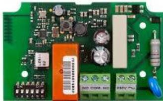
Das Funkausgangsmodul JA-151N (1 A/24 V AC) kopiert den Zustand eines ausgewählten PG-Ausgangs im JABLOTRON 100+-System (PG 1 bis PG 32).
