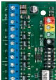
8-kanaliges Bus – Ausgangsmodul bietet insgesamt acht galvanisch getrennte Ausgänge. Zum Beispiel kann es angewendet werden, um optische Anzeigenelemente oder Leistungsrelais zu steuern.
