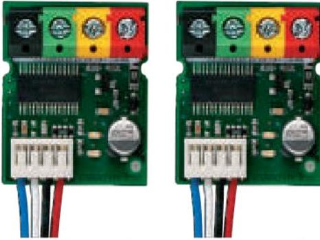
Das Modul JA-111H TRB ist für den Anschluss eines beliebigen drahtgebundenen Melders (mit Kontakt- oder Impulsausgängen) an das System JABLOTRON 100+ vorgesehen und versorgt es mit Strom. Das Modul JA-111H TRB ist für den Anschluss eines beliebigen drahtgebundenen Melders (mit Kontakt- oder Impulsausgängen) an das System JABLOTRON 100+ vorgesehen und versorgt es mit Strom.
