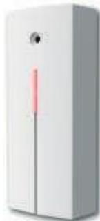
Der JA-110B BUS-Glasbruchmelder erkennt den Bruch bzw. das Einschlagen von Glasfenstern. Dabei wird eine Dualtechnologie (Erkennung der Luftdruckänderung und Geräuschanalyse) angewandt. Die Empfindlichkeit ist einstellbar.
