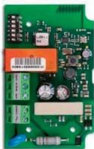
Das Funkausgangsmodul JA-150N (16 A/230 V AC) kopiert den Zustand eines ausgewählten PG-Ausgangs im JABLOTRON 100+-System (PG 1 bis PG 32). 1 programmierbarer Ausgang: 3 Ausgänge (C, NC, NO).
