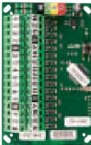
Die Buserweiterung JA-116H bietet die Möglichkeit, bis zu 16 konventionelle festverdrahtete Melder mit den Ausgangskontakten des JABLOTRON 100+-Systems zu verbinden und mit Strom zu versorgen.
