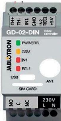
Das Universal GSM-Kommunikations- und Steuergerät GD-02-DIN ermöglicht die Fernsteuerung und -überwachung des Zustands diverser Geräte.
