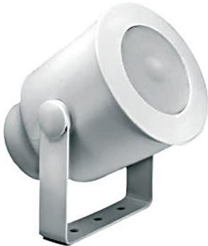
Sound-Projektor, 6 W, weißes ABS-Gehäuse, IP 65, 2-m-Anschlusskabel
