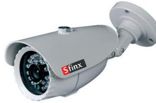
Analoge Videokamera mit externem Aufzählungszeichen und 30 m IR, 1/3 "DIS-Sensor, Festobjektiv (3,6 mm), 600 TVL (Farbe) -Auflösung, Tag / Nacht, mechanisches ICR, IP65-Gehäuse, Betriebstemperatur -10 ° ~ +50 ° Strom 12V DC
