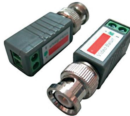
Passiver Videokonverter maximale Entfernung: 400 m / Farbe oder 600 m / Schwarzweiß mit Hochleistung-UTP / FTP-Kabel, passive elektronische Schaltung für Störfestigkeit, ein FTP-Modul an jedem UTP-Kabelende.
