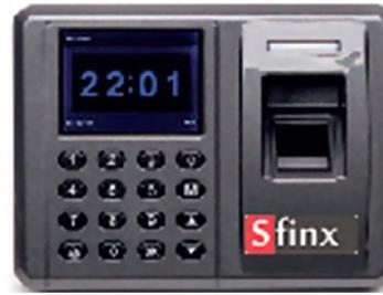
Fingerabdruckleser mit RFID-EM-Proxy-Kartenleser und Tastatur. TCP / IP- und USB-Schnittstelle zur Konfiguration und Steuerung. Konfiguration, um Fingerabdruck + Fingerabdruck + Karte oder Fingerabdruck oder Karte oder Code zu bearbeiten.
