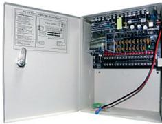
Schaltnetzteil, 12V DC 3A, 4 geschützte Ausgänge 1.1A PTC mit Status LED, 220V A C Eingang, 12V Batterieladung, Metallbox 27.1x21.3x9.4 cm
