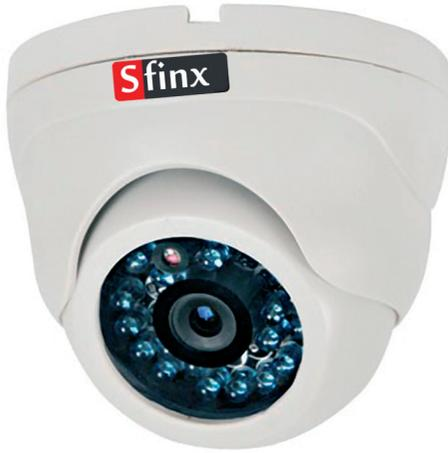
Analoge Außenvideokamera mit IR 20m, 1/3" DIS Sensor, 3,6-mm-Festobjektiv, 600-TVL-Auflösung (Farbe), True Day / Night, mechanisches ICR, IP66-Gehäuse, Betriebstemperatur -10 ° ~ + 50 °, Strom 12V
