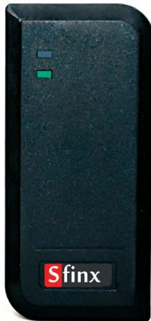
Zutrittsleser, EM prox 125 kHz, Outdoor, Wiegand 26bit Ausgang, 2 LEDs, eingebauter Summer, Leseabstand 3-8cm, Stromversorgung 9-18Vcc, Betriebstemperatur -40'-60'C, Größe 10.20x4.80x2 0,00 cm
