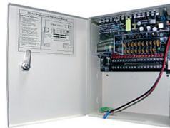
Schaltnetzteil, 12V DC 5A, 9 geschützte Ausgänge 1.1A PTC mit Status LED, 220V AC Eingang, 12V Batterieladung, 27.1x21.3x9.4 cm Metallbox
