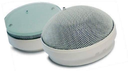
Die Nebula-Melderserie bietet eine optische Erkennung vom Rauch, der durch Brände verursacht wird, gemäß den Normen EN14604: 2005. Es gibt zwei Versionen, eine silberfarbige wie die Deckenlautsprecher und eine mit rundem Glas. Beide haben rote LEDs, um den Alarm anzuzeigen. Es wird von einer 9-V-Leiste mit Strom versorgt und kann durch Anschließen der Funkschnittstelle in einen Funkmelder umgewandelt werden.
